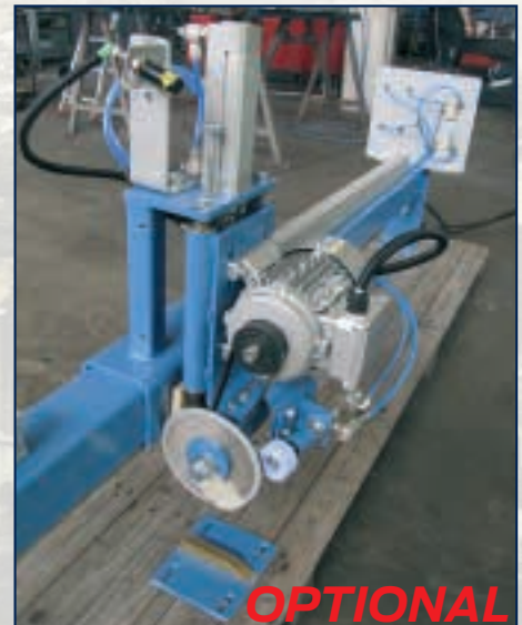
Laser per segnalazione mezzeria / Laser indicating the middle of the leather / Laser que señala la mitad de la piel
