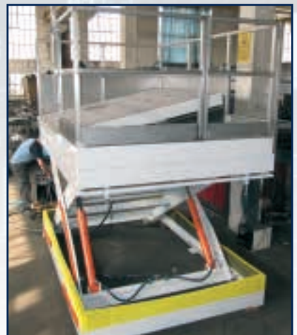
Plattaforma di sollevamento piana e inclinata in Acciaio Inox, con soffiutto / Plane and tilting lifting table made of Stainless Steel, with bellow / Plataforma elevadora plana e inclinada en Acero Inox, con fuelle
