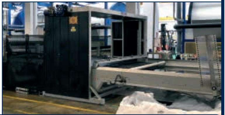
Impilatore dopo Palissone / Stacker behind Staking machine / Apilador para detrás de la máq. de Ablandar
