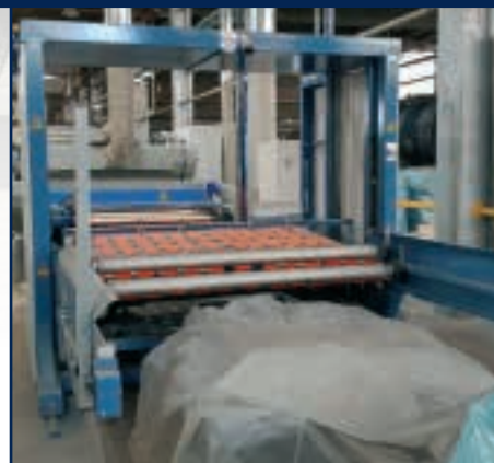
Impilatore dopo Spazzolatrice e Smerigliatrice / Stacker behind Brushing machine and Buffing machine / Apilador para detrás de la Cepilladora y Esmeriladora
