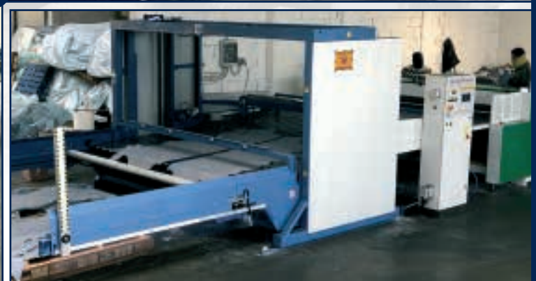
Impilatore in acciaio al carbonio verniciato con taglierina / Painted carbon iron Stacker with cutting device / Apilador en hierro al carbono barnizado con cortadora
