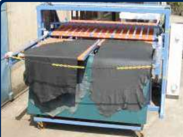
Impilatore a due carri / Stacker with double trolley / Apilador de dos carros
