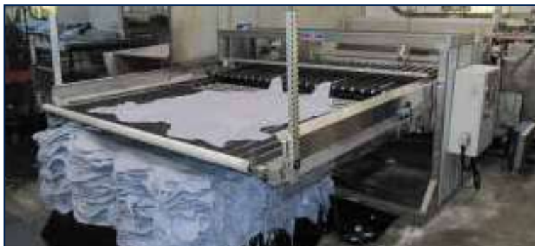
Impilatore inox dopo Pressa wet blue / Stainless steel Stacker behind wet blue Sammying machine / Apilador en acero inox para detrás de la Prensa de escurrir wet blue
