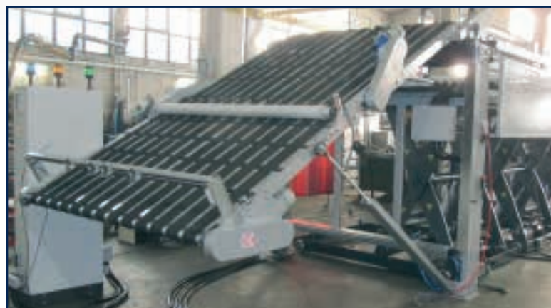
Impilatore a 3 scelte / Stacker with 3 selections / Apilador de 3 selecciones
