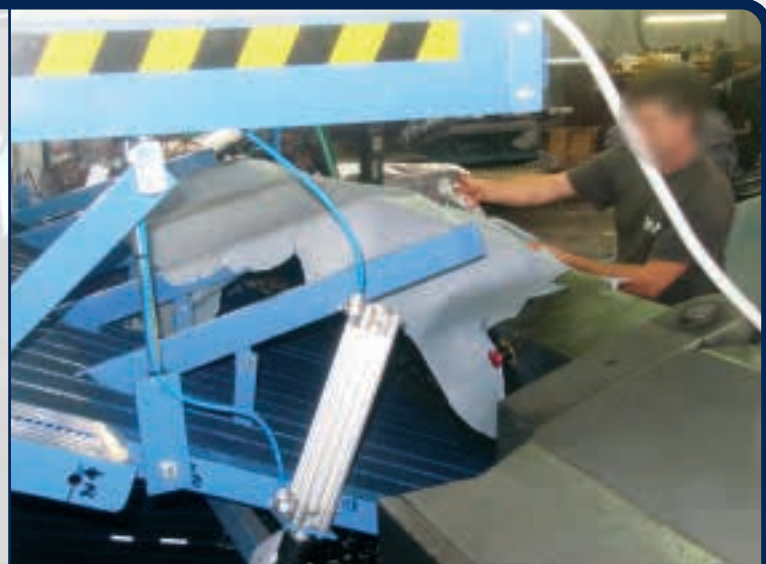
Sistema di sollevamento pelle per controllo spessore / System to lift the leather for thickness checking / Sistema de levantamiento piel para controlar el espesor
