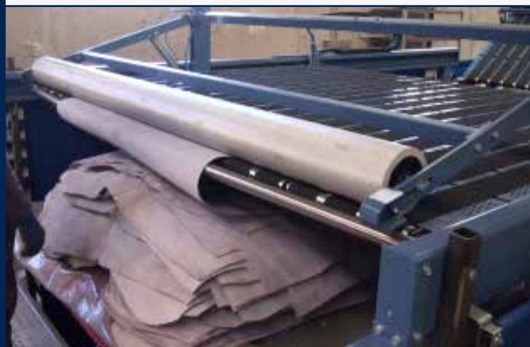
Impilatore a 11 scelte / Stacker with 11 selections / Apilador de 11 selecciones
