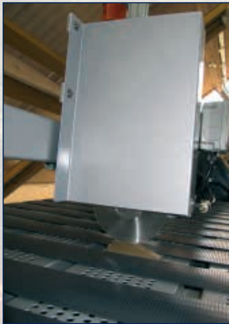
Laser per segnalazione mezzeria / Laser indicating the middle of the leather / Laser que señala la mitad de la piel
