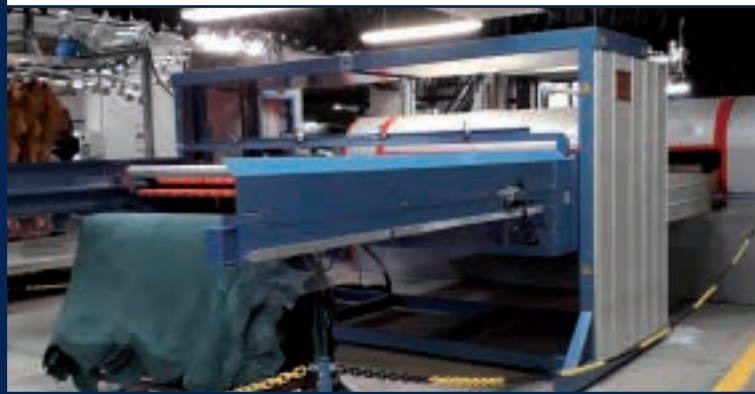
Impilatore dopo Palissone / Stacker behind Staking machine / Apilador para detrás de la máq. de Ablandar
