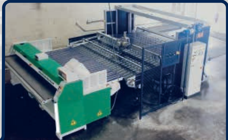
Laser per segnalazione mezzeria / Laser indicating the middle of the leather / Laser que señala la mitad de la piel
