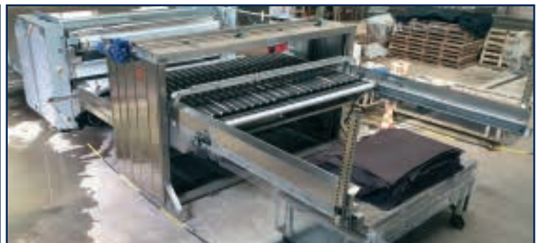
Impilatore inox dopo Pressa wet blue / Stainless steel Stacker behind wet blue Sammying machine / Apilador en acero inox para detrás de la Prensa de escurrir wet blue
