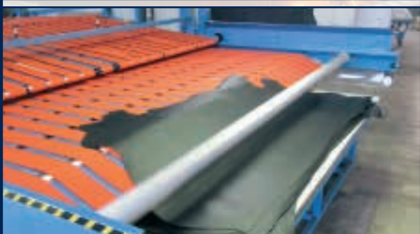
Impilatore con scivolo / Stacker with chute / Apilador con declive
