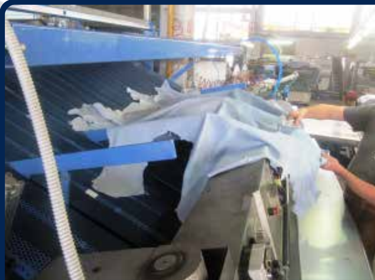
Sistema di sollevamento pelle per controllo spessore / System to lift the leather for thickness checking / Sistema de levantamiento piel para controlar el espesor
