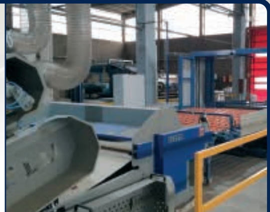
Impilatore dopo Spazzolatrice e Smerigliatrice / Stacker behind Brushing machine and Buffing machine / Apilador para detrás de la Cepilladora y Esmeriladora
