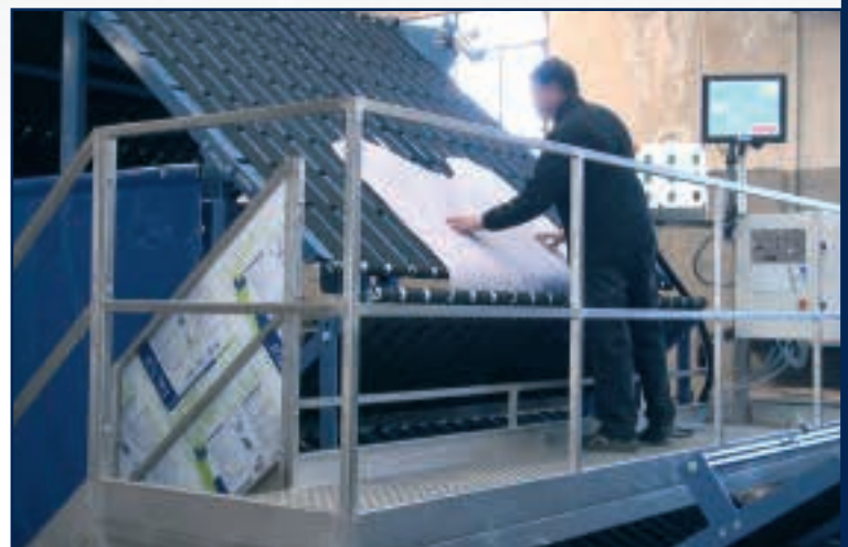
Impilatore a 11 scelte / Stacker with 11 selections / Apilador de 11 selecciones
