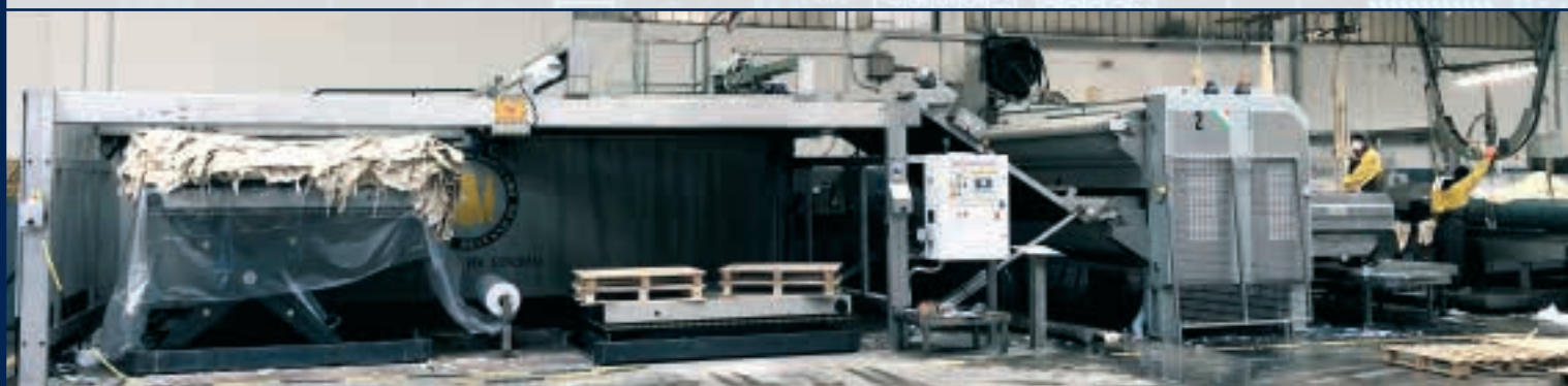
Impilatore a 2 scelte / Stacker with 2 selections / Apilador de 2 selecciones
