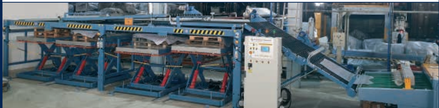
Impilatore a 4 scelte / Stacker with 4 selections / Apilador de 4 selecciones
